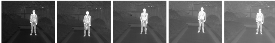
Afbeelding 3-4 Helderheid aanpassen in wit-heetmodus
