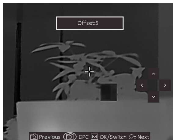
Afbeelding 3-5 Defecte pixel corrigeren
